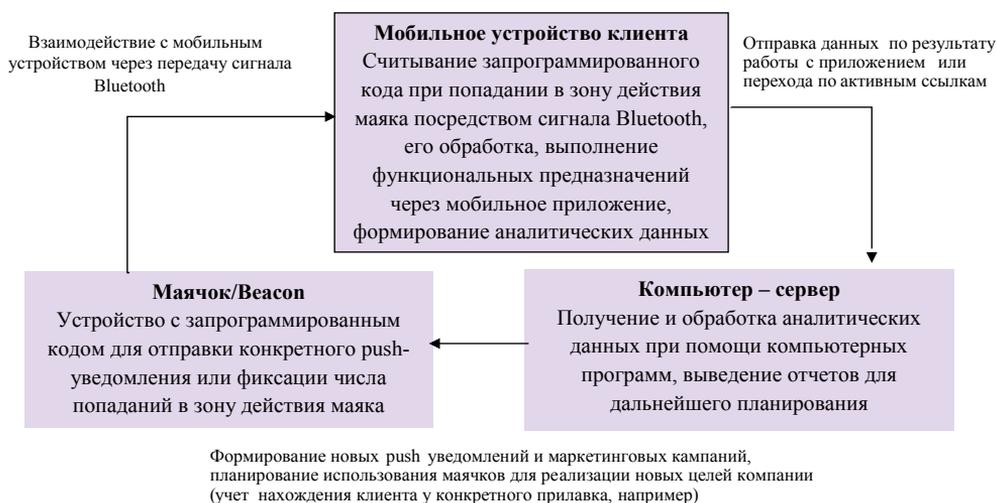
Рисунок 1. Принципиальная схема работы технологии «iBeacon»
