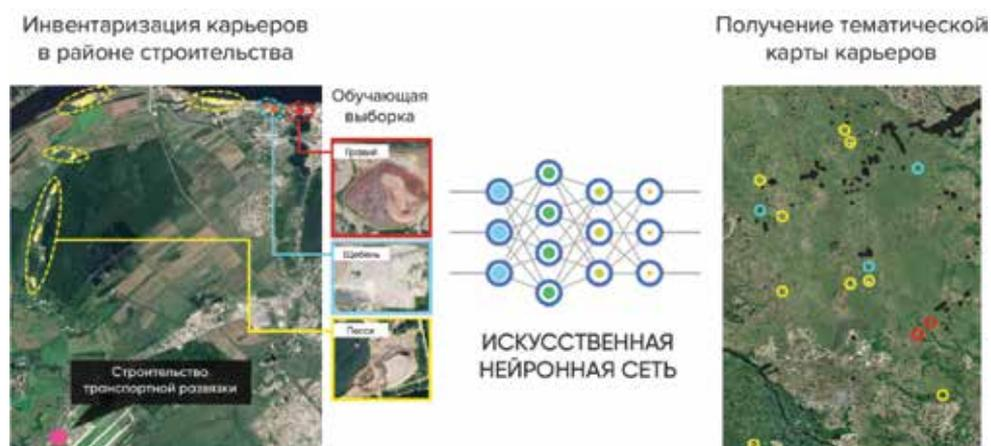
**Рисунок 4.** Спутниковый сервис инвентаризации карьеров с использованием нейросетевых технологий
